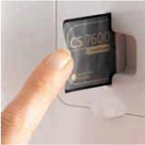
L'insertion incorrecte d'une plaque est automatiquement détectée. Des enveloppes hygiéniques protègent les plaques pendant le fonctionnement.
